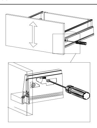
Mit Betätigung der hinteren Schraube wird die Front in der vertikalen Richtung eingestellt!
