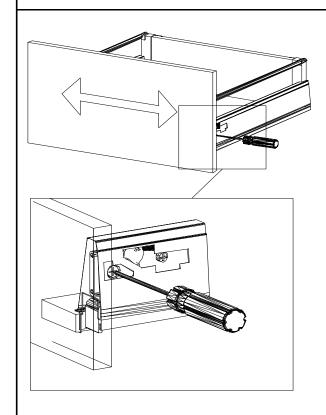
Mit Betätigung der vorderen Schraube wird die Fronteinstellung in horizontaler Richtung vorgenommen!
