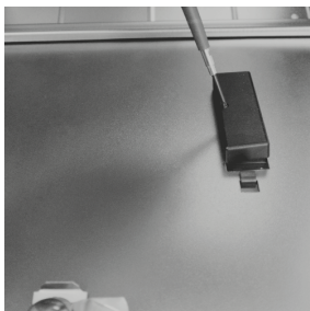
3. ábra: Nyissa ki az akkumulátortartó rekeszt fedélét
