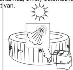
A levegő kitágul a nap közbeni melegben. A légnomás kiengedő szelep kiengedi a felesleges levegőt.
