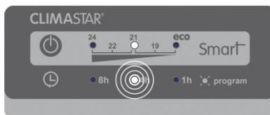
Zariadenie je nastavené na pripojenie a odpojenie každé 4 hodiny. Ak bol ohrievač nastavený na 20.00, začne pracovať, ako je zobrazené nižšie.
